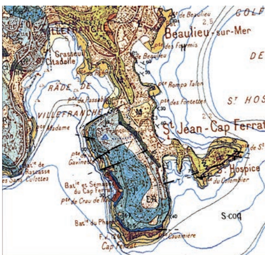
Figure 3 Extrait de la carte géologique du BRGM au 1/50.000ème, feuille Menton/Nice (modifié d'après Gèze et al. 1996). Plusieurs failles normales, de direction sensiblement ENE-WSW, qui découpent le Cap Ferrat en divers tronçons, sont visibles (traits noirs).
